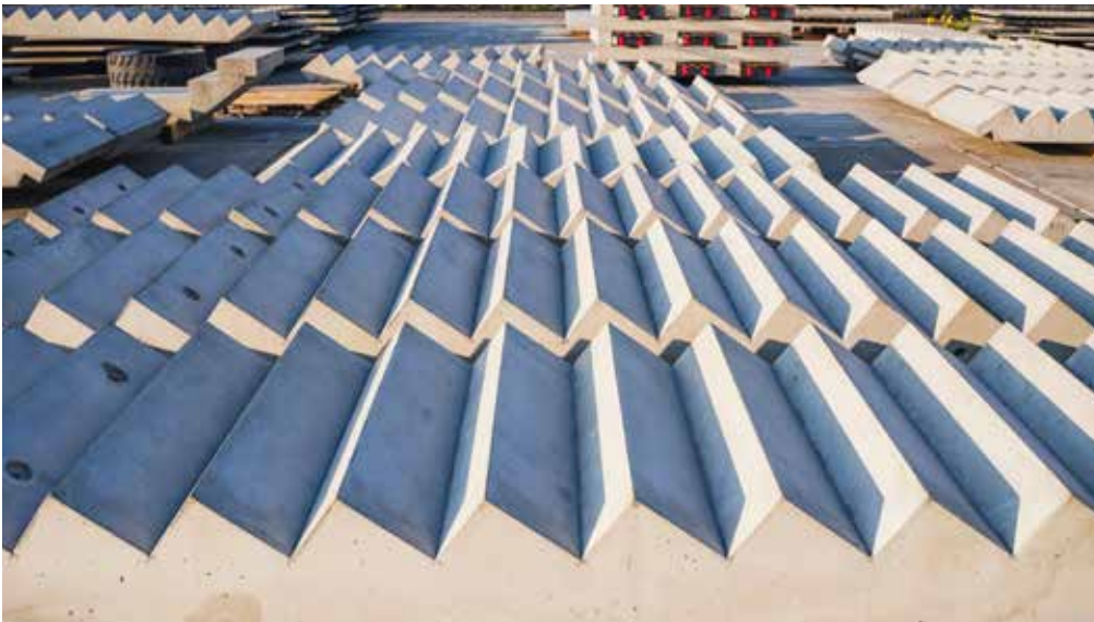
Żelbetowe schody prefabrykowane jednobiegowe
