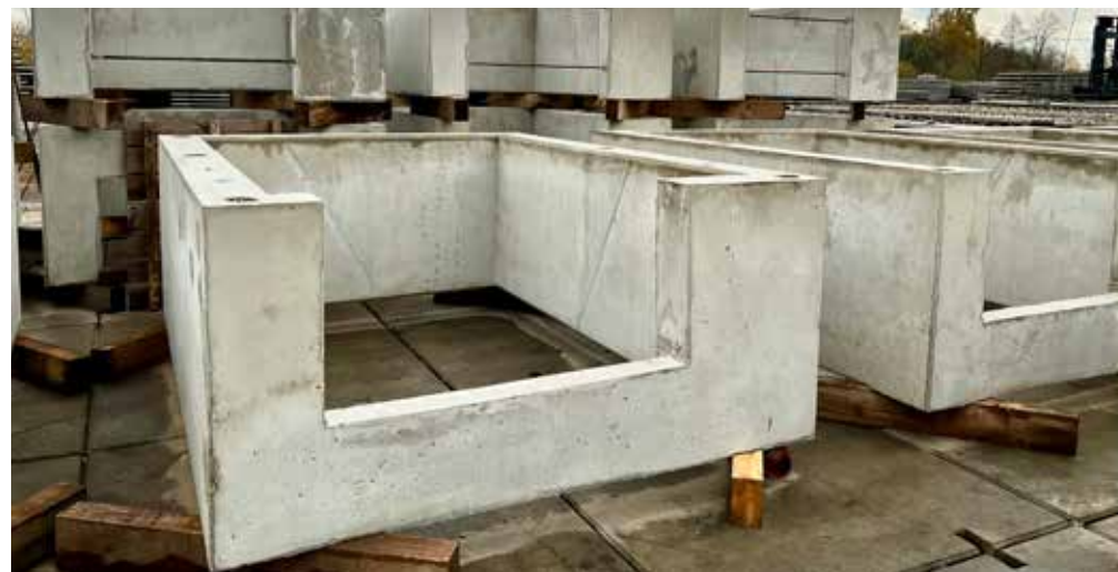
Prefabrykowane szyby windowe przygotowane do transportu
