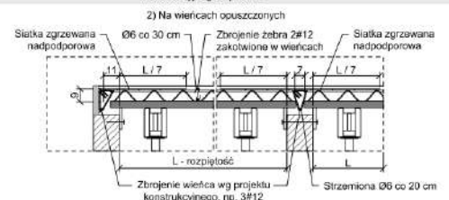
Dozbrojenie przy oparciu płyt < 6 cm
