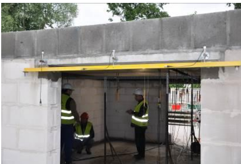
Rys. 10. Montaż czujników indukcyjnych do pomiarów przemieszczeń pionowych (Model 1 i Model 2)
