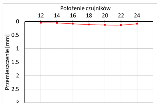
Rys. 12. Schemat obciążenia B: a) widok górnej powierzchni stropu, b) rozkład obciążenia, c) deformacja przestrzenna Modelu 1, d) deformacja przestrzenna Modelu 2, e) przemieszczenia stropu wzdłuż osi otworów, f) przemieszczenia stropu wzdłuż osi prostopadłej do osi otworów
