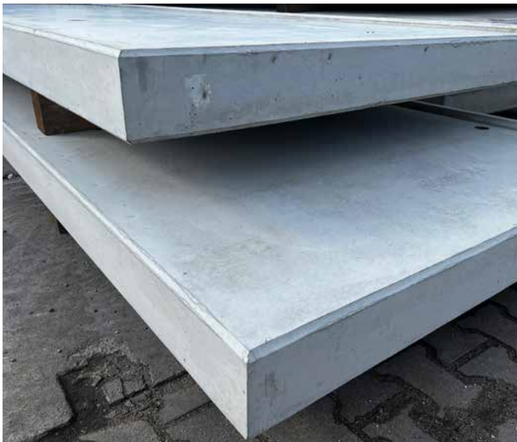
Płyty balkonowe przygotowane do transportu
