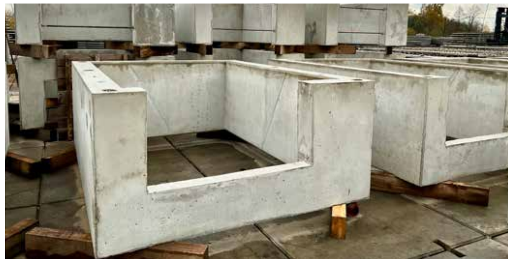
Prefabrykowane szyby windowe przygotowane do transportu
